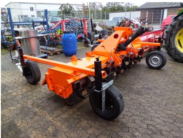
La fraise repose sur des roues et travaille à faible profondeur
