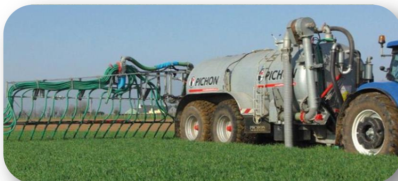
Tonne à lisier équipée d'une rampe de pendillards
