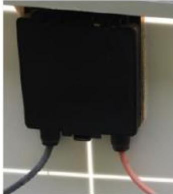
C'est au sein de cette boîte de jonction, en face arrière du panneau, que les diodes bypass sont branchées en parallèle d'une série de cellule pour court-circuiter la série de cellule si l'une d'entre elle a un comportement récepteur et se met à consommer le courant produit par les cellules voisines.
